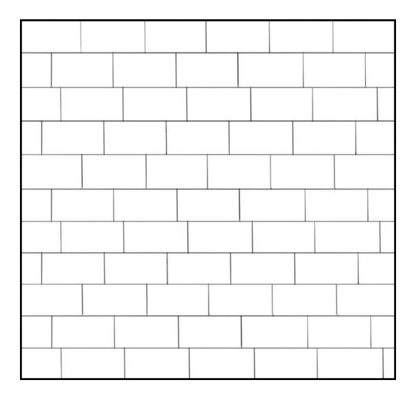
Beim Verlegemuster **freilaufender Verband** wird mit den Steinplatten der nächsten Reihe stets an andere Stelle als in der vorigen Reihe begonnen. Hierbei ist darauf zu achten, dass keine Kreuzfugen entstehen.
